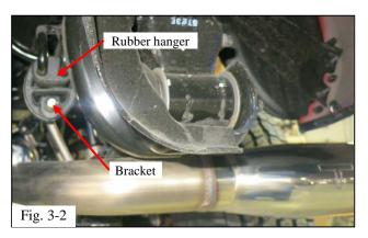
(d) Pry the tailpipe bracket loose from the rubber hanger (Fig. 2-3).
