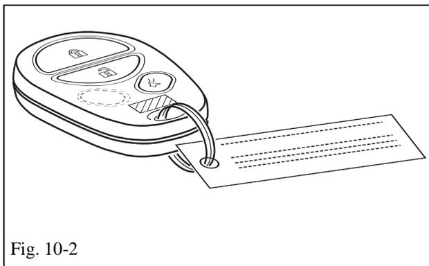
(d) Attach the Remote Engine Starter Key Tags to the Vehicle Remotes. (Fig. 10-2)
