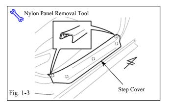
(d) Remove the Passenger's step cover. (Fig. 1-3)
